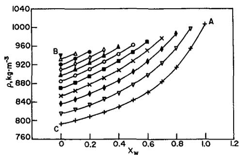
Fig. 8. Density  $\rho$  versus  $x_w$  (water content) for various  $x_d$  (diacetone content) at  $P=40$  MPa and  $T=323.15$  K. (+:  $x_d=0$ ,  $\nabla$ : 0.1,  $\blacklozenge$ : 0.2,  $\times$ : 0.3,  $\blacksquare$ : 0.4,  $\circ$ : 0.5,  $\blacktriangle$ : 0.6,  $\diamond$ : 0.7,  $\bullet$ : 0.8,  $\triangle$ : 0.9,  $\blacktriangledown$ : 1).
