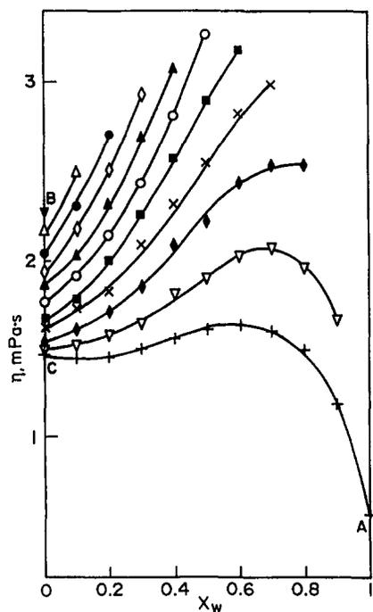
Fig. 9. Dynamic viscosity  $\eta$  versus  $x_w$  (water content) at  $P=40$  MPa and  $T=323.15$  K. (+:  $x_d=0$ ,  $\nabla$ : 0.1,  $\blacklozenge$ : 0.2,  $\times$ : 0.3,  $\blacksquare$ : 0.4,  $\circ$ : 0.5,  $\blacktriangle$ : 0.6,  $\diamond$ : 0.7,  $\bullet$ : 0.8,  $\triangle$ : 0.9,  $\blacktriangledown$ : 1).
